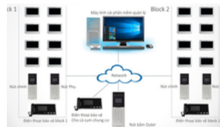
Hệ thống intercom kết nối căn hộ kí túc xá
